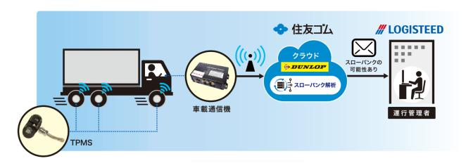
トラックに装着したタイヤ空気圧監視システム(TPMS)によって、タイヤ空気圧と温度をモニタリングします。走行時にタイヤに異常が生じた際には、ドライバーに通知され、車載用通信機からクラウドを通じて運行管理者にもメールで通知されます。一般的なタイヤ空気圧点検では見つけることが難しいとされているスローパンク\*1 も早期発見することが可能です。タイヤトラブルによる車両の稼働停止時間(ダウンタイム)を短縮するとともに、ドライバーと積荷の安全を守ります。さらに適正な空気圧管理による燃費向上や、当システムを活用した運行前点検の効率化にも寄与します。
