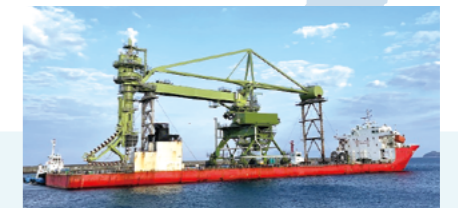
国内港湾向け荷役設備の自航式バージによる輸送
